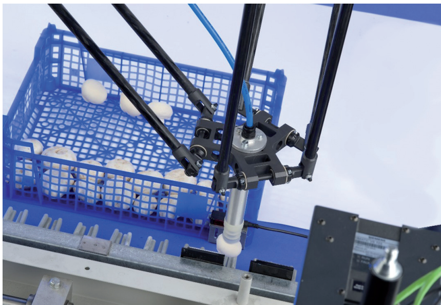
Via een band aangevoerde champignons worden met de SiWays-Spider-robot in een bak overgebracht.
