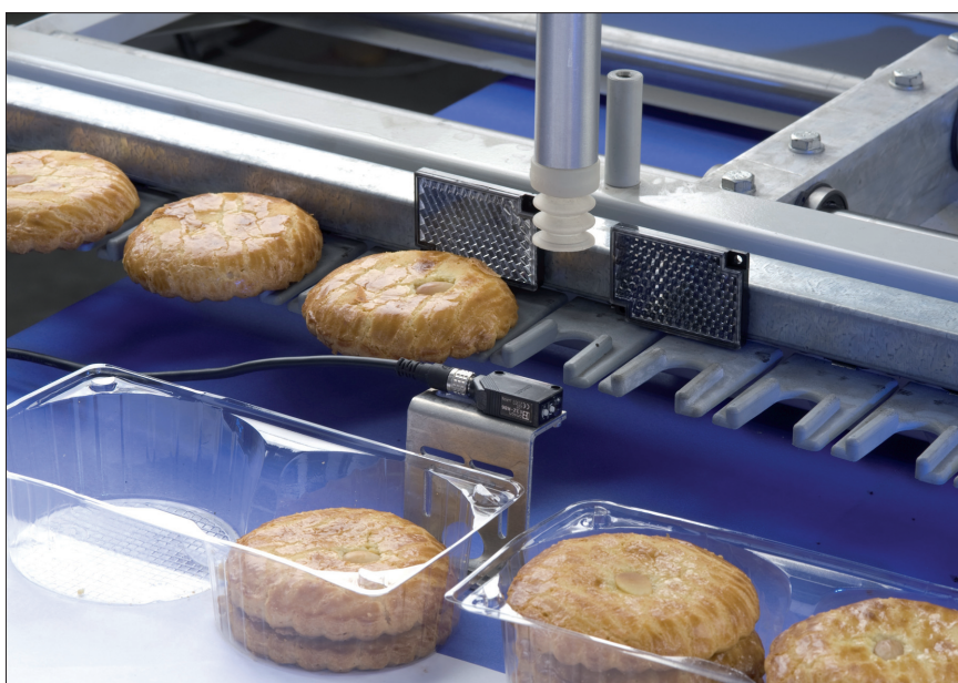
Plaatsing van koeken in een plastic tray met behulp van de SiWays-Spider.
